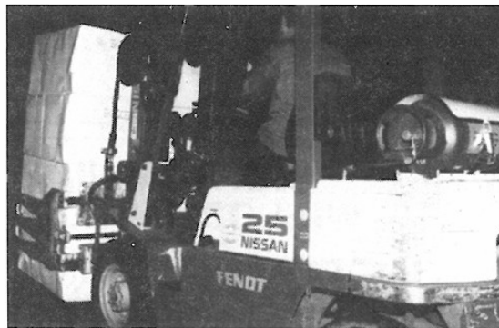
Nowy wózek szczękowy o napędzie gazowym firmy Nissan podczas przewozu celulozy.
